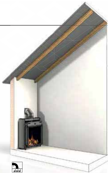
Direkt durch die Wand • direkt am Kamin mit 90° Bogen durch die Außenwand unter Beachtung der Länder-spezifischen Bauordnungen. • für einen Teil des Sortiments lieferbar
